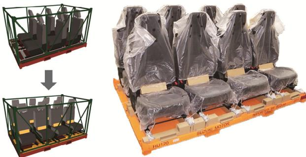
従来海外向けシート(座席)の発送荷姿には、以下の課題があった。①収容効率が悪い ②スチール材のためコストが高い ③固定時にシートをスライドさせ、36 本のボルト締めなど、作業性が悪い。
