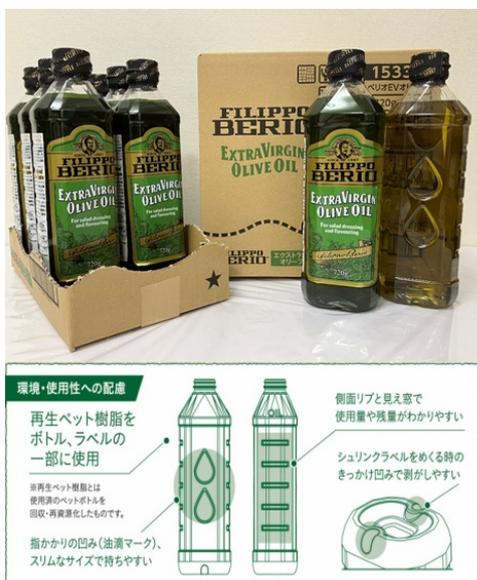
既存の910gエコペットからユーザビリティの向上と環境対応を新たに加えた720gUDエコペットを開発した。ボトルとラベルには再生PET樹脂を一部配合した。ボトル側面の角をできるだけ落として楕円形状にし、手にやさしくフィットするようにした。ボトル中央部には当社ロゴの油滴マークの窪みをつけて指をかけて握りやすくした。シュリンクラベルは一般的にボトルとの密着性が高く剥がしにくいですが、ボトル底部に窪みをつけてきっけとすることで剥がしやすくした。段ボールは手で簡単に開けられる易開封ミシンを採用したSRP仕様にて小売店での開封・陳列作業の省力化を図っている。
